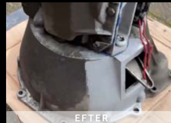
Afrensning olierester mm. på gearkasse i aluminium
